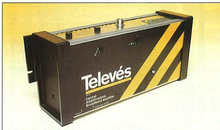
Se trata de una central toda banda (47-862 MHz) de 39 de ganancia y 120 dB $\mu$ V de tensión de salida para dos canales (norma DIN 45004B).
