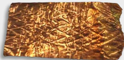
Lámina con cobre, después de quemarse
