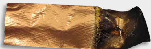
Lámina sin cobre (con pigmento), después de quemarse
