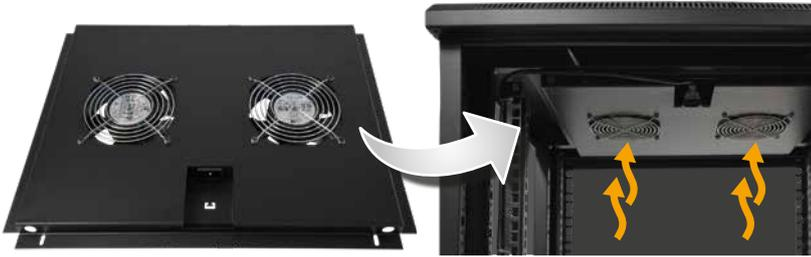
Sí, siempre que se alojan dispositivos activos en un rack es **necesario instalar sistemas de ventilación forzada**. De esta forma, se favorece la disipación de calor de los componentes electrónicos y se mantiene un rango de temperaturas adecuado. Un rack sin ventilación actuaría como una caja cerrada, acumulando el calor generado por los equipos y elevando la temperatura de su interior.
