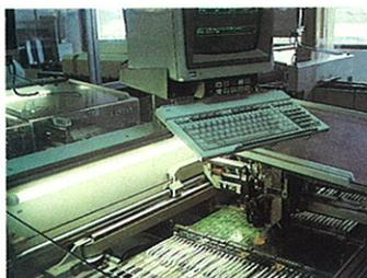
**SMD.** Montaje superficial de componentes. En esta línea de producción, es donde se montan los microchips que incorporan vida al conjunto del circuito. Se trata de un proceso robotizado revolucionario del que Televés es pionero de su implantación en Europa.
