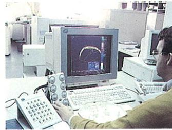
**CATIA.** Paralelamente al proceso de I+D y del desarrollo electrónico de la Antena Nova, se diseña y da forma exterior por medio del CATIA a la carcasa de plástico que protegerá el cerebro de la nueva antena.
