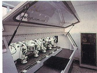
**CNC,** la mecanización. La mecanización por procesos controlados informáticamente, garantizan con precisión centesimal la ejecución del circuito impreso, sus contornos y perforaciones.
