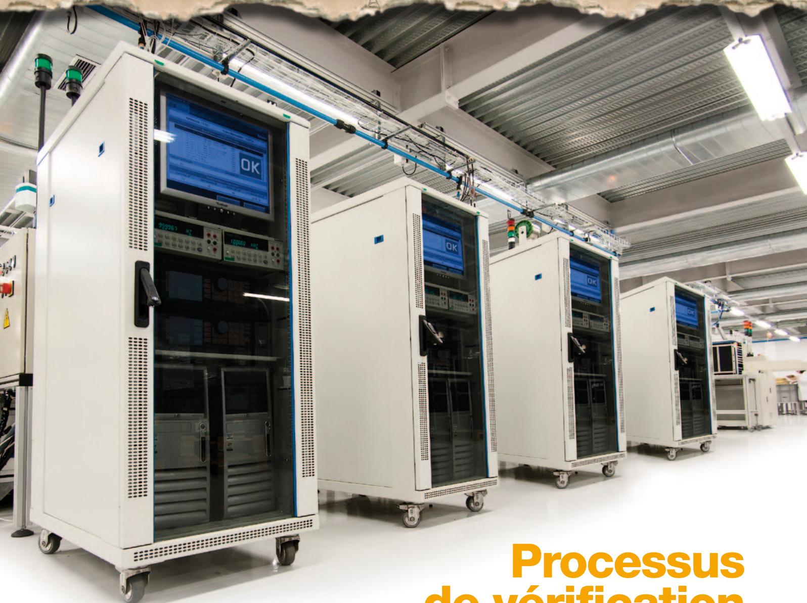
Au milieu des années 90, Televés a commencé à déployer sa volonté d'automatisation industrielle vers ses processus de vérification. Il était nécessaire d'atteindre au moins le même niveau d'efficacité que les contrôles réalisés manuellement.
