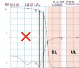
Filtro che deforma il segnale DTT. Inutile l'alto taglio sull'UpLink
