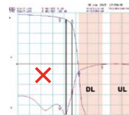
Filtr deformujący sygnał DVB-T. Zbyt duża separacja w Uplink.
