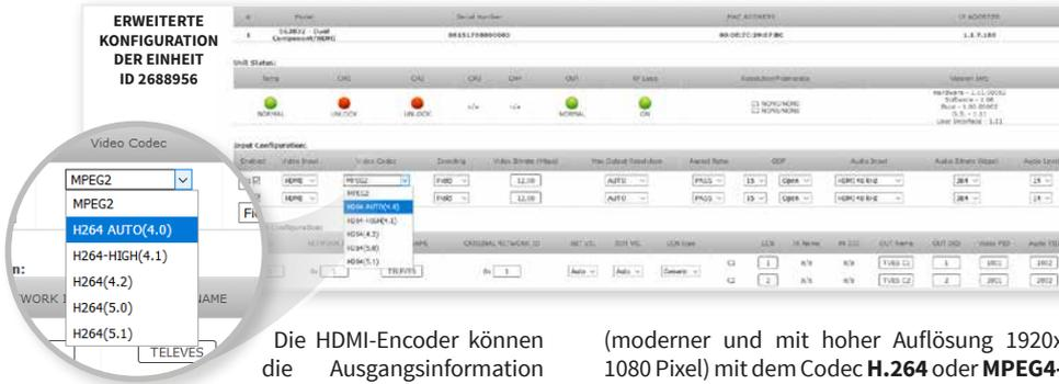
Die HDMI-Encoder können die Ausgangsinformation unter Verwendung verschiedener Video-Codex mit niedriger oder hoher Kompression codieren, wobei die Bitrate an das verwendete Wiedergabegerät angepasst wird. In unserem Fall handelt es sich um DVB-T/C-Empfänger oder Fernsehgeräte mit integriertem DVB-T/C-Empfänger.
