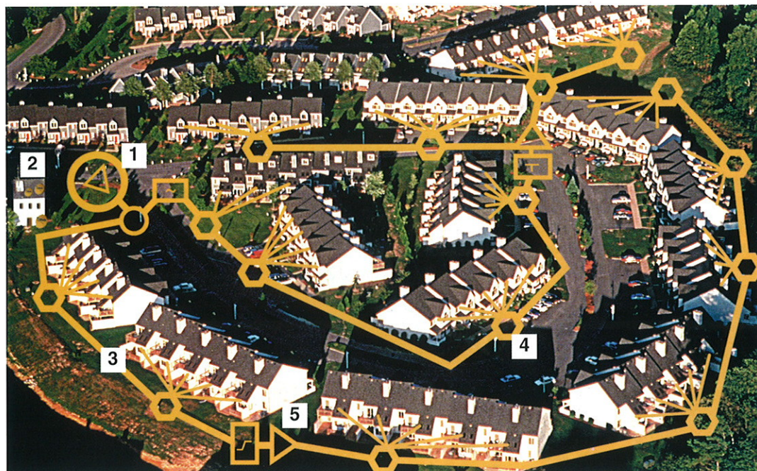
1. Estación de Cabecera 2. Sistema Captador 3. Línea 4. Elementos distribución 5. Amplificación de línea
