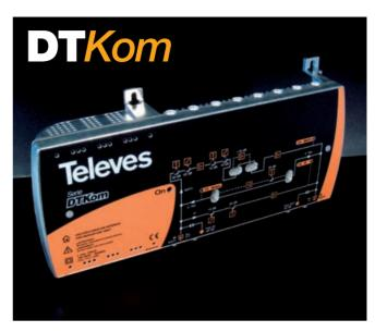
A Central de Amplificação para SMATV, ref.533501 torna-se num equipamento mais versátil uma vez que possui três circuitos independentes de amplificação, a Via Directa dos 87MHz aos 862MHz, a Fl dos 950MHz aos 2150MHz e a Via de Retorno 5-65 MHz. Apresenta um nível de saída máximo de 124 dBμV em MATV e 121 dBμV em Fl de acordo com a DIN 45004B permitindo assim ser instalada simultaneamente em redes de MATV, SMATV ου CATV.
