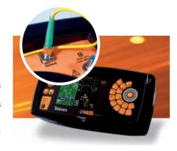
Medidor de Campo H45 possui 2GHz (950MHz a 2500 MHz) de SP AN dotando assim a medida de uma análise completa
