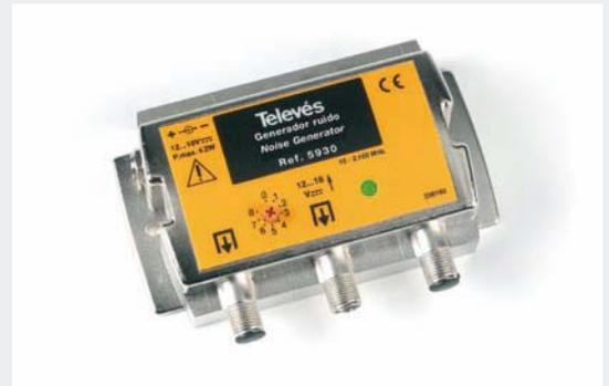
A ref. 5930 gera ruído dos 5MHz aos 2150MHz, e é adequado para os ensaios ITED2. No entanto pode também ser utilizado nos ensaios do ITED1, para os níveis de qualidade NQ2a e NQ2b. Como gera ruído por toda a banda tem a vantagem de se poder analisar em espectro e assim detectar qualquer possível falha na instalação, como recomendado no manual ITED2 no ANEXO B, "Procedimento em caso de falha nos ensaios das redes coaxiais".
