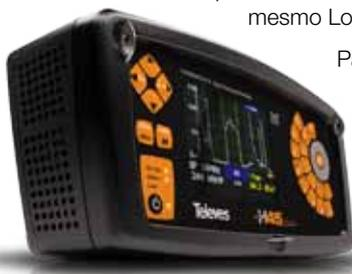
Como funcionalidades mais importantes destaca-se a gravação das medidas no H45 através da utilização de uma Macromedida podendo-se simultaneamente visualizar os parâmetros medidos em cada ponto da instalação em tempo real. Assim é possível gravar a medida ou simplesmente descartar a mesma e repetir o processo. Caso seja necessária intervenção na instalação poder-se-á interromper a Macromedida através da tecla CLEAR. Posteriormente é possível continuar o processo de medida no mesmo Log.
