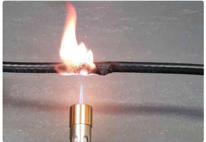
Brandversuch mit einem PVC-Kabel, bei dem sich herausstellt, dass es leichter entflammbar ist und Dämpfe abgibt.
