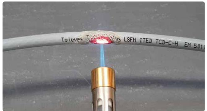
Brandtest mit einem LSFH-Kabel, bei zu beachten ist, dass es keinen Rauch entwickelt und die Ausbreitung von Flammen minimiert.
