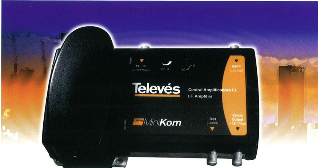
Esta central alberga un amplificador de FI.(950-2.200 MHz) y fuente de alimentación conmutada de bajo consumo. Dispone de una entrada para mezcla de señales de MATV que contiene un potente filtro paso bajo. Todo ello alojado en chasis de zamak inyectado con conectores F.
