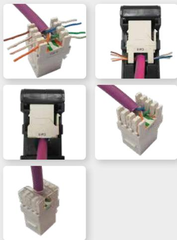
Televés lancia la nuova pinza per terminazione e taglio Art. 209811, compatibile con i suoi connettori femmina CAT6 UTP Art. 209901. Grazie a questo utensile, la connettorizzazione risulta notevolmente più semplice e si risparmia tempo nell'assemblaggio. La pinza permette di inserire agevolmente le 4 coppie sui relativi pin e di tagliare il cavo in eccedenza senza la necessità di altri attrezzi.
