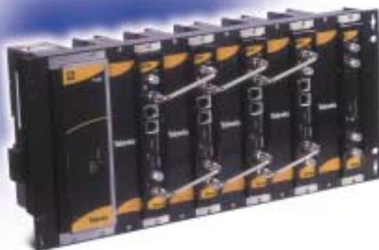
El transmodulador QPSK-PAL vuelca un canal de TV ó radio (seleccionado por el instalador) de entre los canales existentes en un transpondedor de satélite (modulación QPSK y ancho de banda aproximado de 36MHz) en un canal de VHF/ UHF (modulación según standard PAL y ancho de banda 7/8 MHz).
