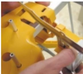
El dipolo se posiciona al cuerpo mediante un sistema tipo "clack"
