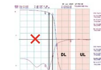
Filtro que deforma o sinal TDT. Desnecessário alta rejeição no UpLink
