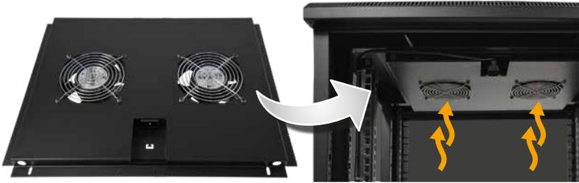
Sì, ogniqualvolta vengono collocati dispositivi attivi in un rack, è **necessario installare sistemi di ventilazione forzata**. In questo modo, si favorisce la dissipazione del calore dei componenti elettronici e si mantiene un intervallo di temperature adeguato. Un rack senza ventilazione si comporterebbe come una scatola chiusa, accumulando il calore generato dalle apparecchiature e facendo innalzare la temperatura all'interno.
