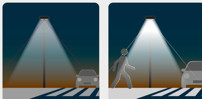
un **angle de 180°**, s'activent en détectant les personnes sur le **trottoir**, mais ne réagissent pas au passage de véhicules sur la chaussée. Ils communiquent également entre eux par Bluetooth pour **synchroniser les luminaires de chaque côté du passage piétons** et les activer simultanément. Il s'agit d'une **alternative intelligente pour éclairer les passages piétons et renforcer la sécurité publique** ■
