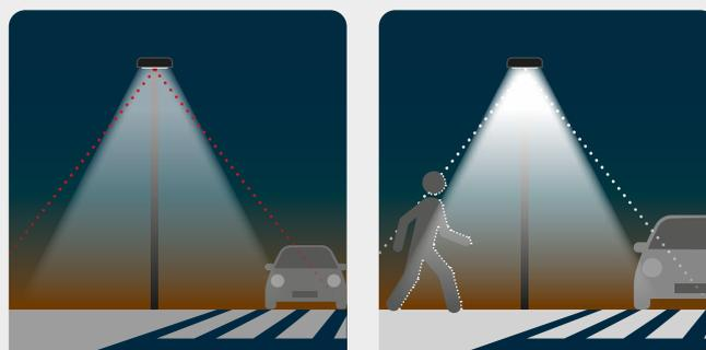
con un **angolo di 180°**, si attivano quando rilevano persone sul marciapiede, ma ignorano i veicoli sulla strada. Inoltre comunicano tra loro tramite Bluetooth per **sincronizzare gli apparecchi su entrambi i lati dell'attraversamento pedonale** e attivarsi simultaneamente. Si tratta di un'**alternativa intelligente per illuminare gli attraversamenti pedonali e migliorare la sicurezza pubblica** ■
