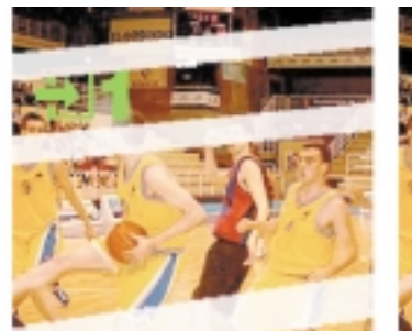
Recepción de señal analógica con antena interior convencional: interferencias provocadas por telefonía móvil.
