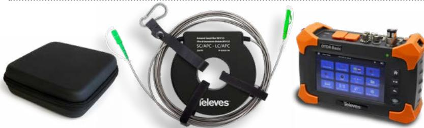
Fibre de lancement (réf. 23619x / 23099x) avec boîtier et OTDR Basic (réf. 598001)
