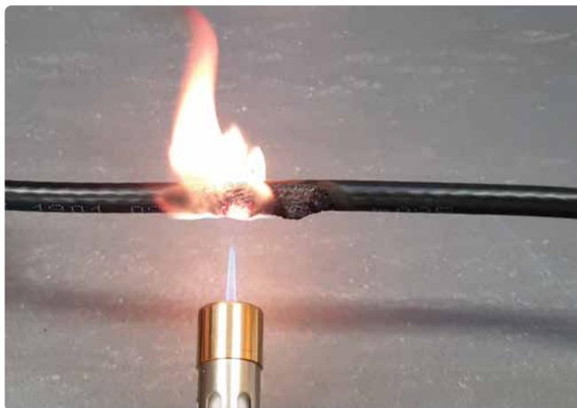
Essai de sécurité incendie sur un câble PVC, où l'on constate qu'il est plus inflammable et qu'il émet des fumées.
