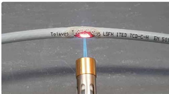
Essai de sécurité incendie sur un câble LSFH, où l'on constate qu'il n'émet pas de fumée et que la propagation des flammes est minimisée.
