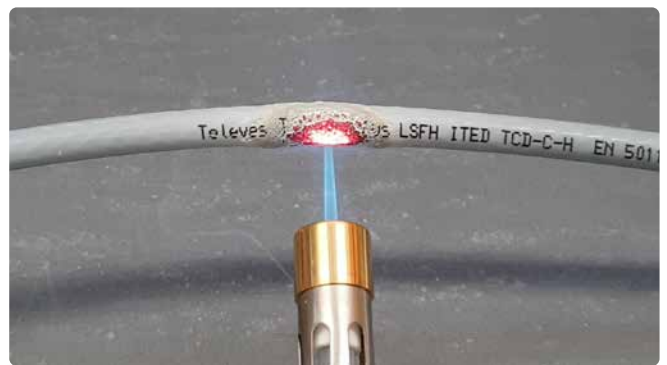
Prova del fuoco con un cavo in LSFH, dalla quale risulta che non emette fumi e riduce al minimo la diffusione delle fiamme.
