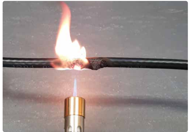
Prova del fuoco con un cavo in PVC, dalla quale risultano maggiore infiammabilità ed emissione di fumi.
