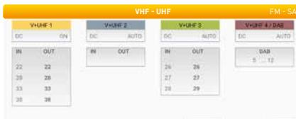
Sur le même écran principal, nous choisissons le niveau de sortie souhaité et si nous voulons égaliser la sortie avec une pente.
