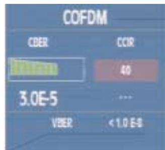
*detalle de medida del BER en un canal terrestre. Las barras de color verde indican buena calidad de señal*
