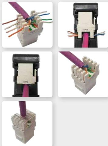
A Televes lança a sua nova ferramenta de terminação e corte, ref. 209811, compatível com os seus conectores fêmea CAT6 UTP, ref. 209901. Graças a esta ferramenta, simplifica-se muito a ligação e ganha-se tempo considerável na montagem, já que, por um lado, insere de maneira simples os 4 pares nos seus pinos e, por outro corta o restante fio que sobra sem necessidade de nenhuma ferramenta adicional.
