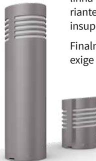
A estrutura destas balizas foi concebida para **resistir nos meios hostis**. Fabricada em aço inoxidável de 3 mm de espessura, é muito **resistente à corrosão** provocada pela humidade, neve ou chuva e outros efeitos meteorológicos adversos. Por outro lado, a série Arousa também está preparada para lugares mais difíceis ou recônditos, já que apresenta uma **resistência a impactos** de nível IK10 e uma proteção especial de **verniz incolor anti grafites**.
