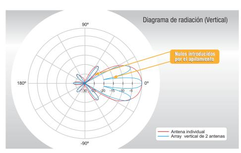
es la separación entre antenas,  $\alpha$  el ángulo en el que se produce el nulo y  $\lambda$  la longitud de onda. Esto puede ser muy útil para discriminar señales reflejadas y evitar dobles imágenes.
