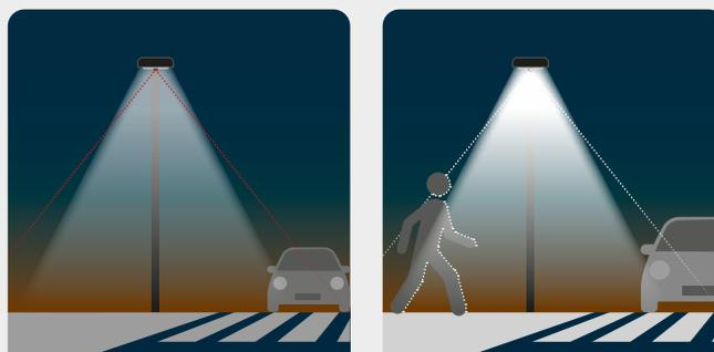
entre si por Bluetooth, para **sincronizar as luminárias de ambos os lados da passeadeira de peões** e ativá-las simultaneamente. Trata-se de uma **alternativa inteligente para iluminar as passagens de peões e reforçar a segurança dos cidadãos** ■
