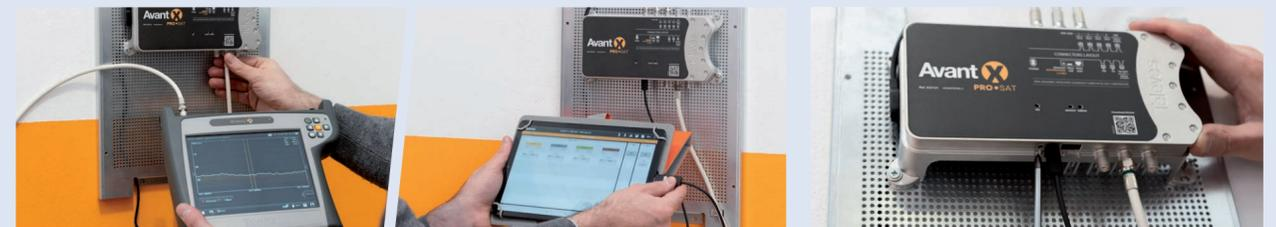
**5. COLLEGARE** un misuratore di campo sul connettore RF di uscita e un device con app Asuite per verificare l'operazione di auto-configurazione
