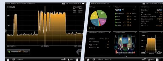
**7. AL TERMINE** della procedura, spento il Led ADJUST, verificare l'equalizzazione e la qualità del segnale di uscita sul misuratore di campo
