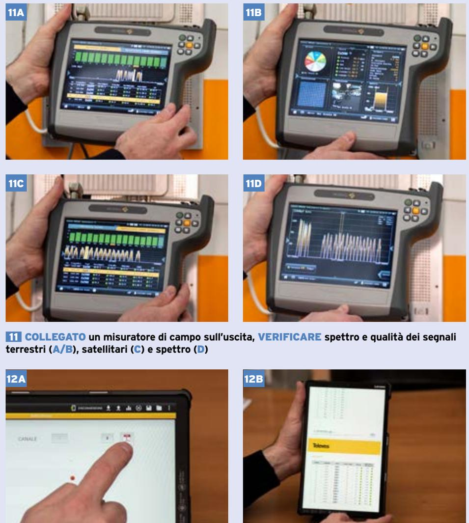
**11 COLLEGATO** un misuratore di campo sull'uscita, **VERIFICARE** spettro e qualità dei segnali terrestri (A/B), satellitari (C) e spettro (D)
